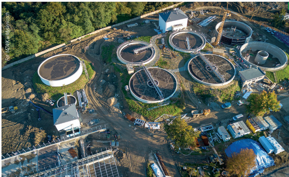
OCZYSZCZALNIA W CZASIE MODERNIZACJI Widoczne osadniki wtórne, komory biologiczne, budynek oczyszczania mechanicznego i recyrkulacji, komora stabilizacji tlenowej, zagęszczacz osadu, stacja odwadniania oraz suszarnie słoneczne – w budowie
